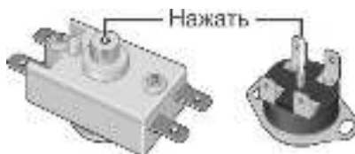
Рисунок 3. Возможные схемы расположения кнопки термовыключателя
